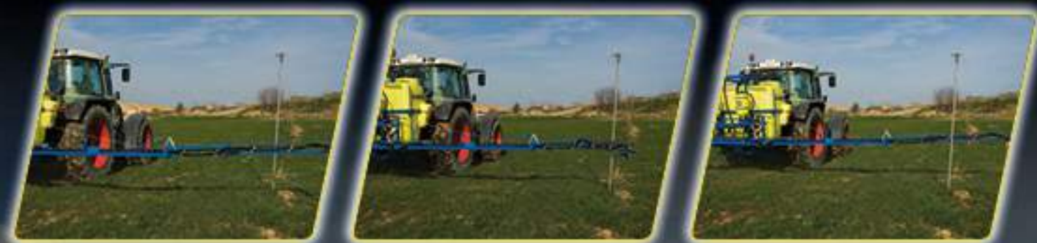
Puntas de barra con dispositivos de seguridad anti-rotura.
