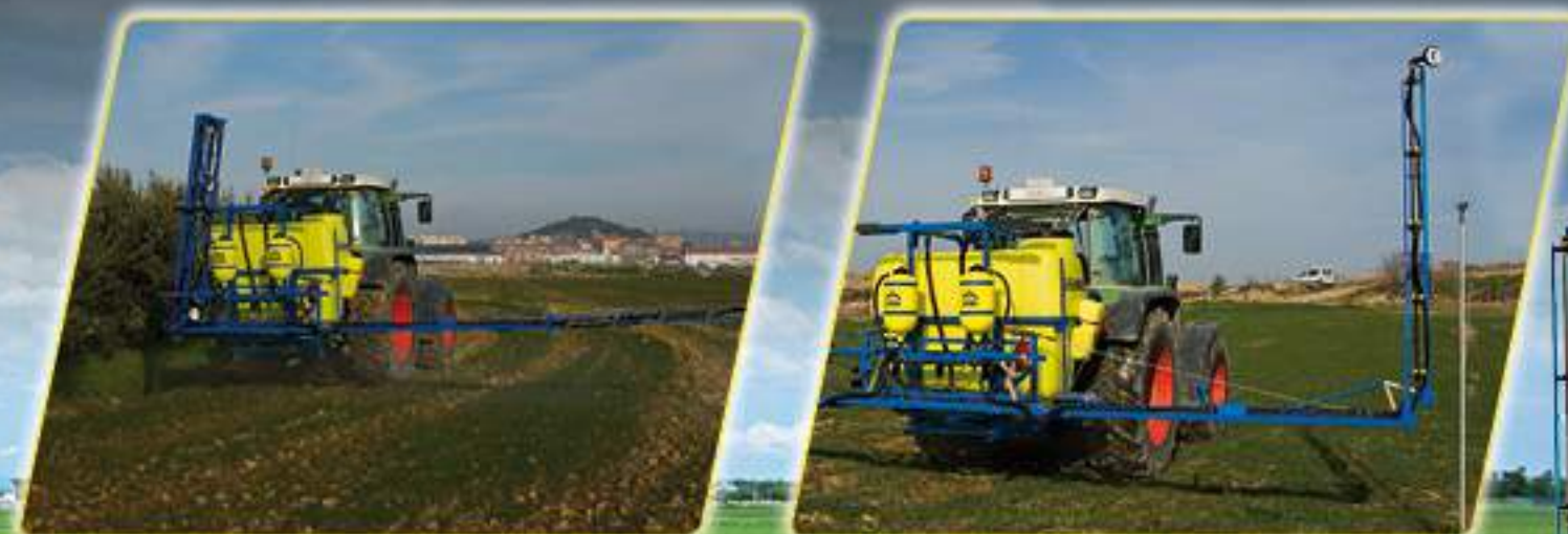
Sistema automático de bloqueo de media barra para trabajar hacia el interior de las parcelas.
