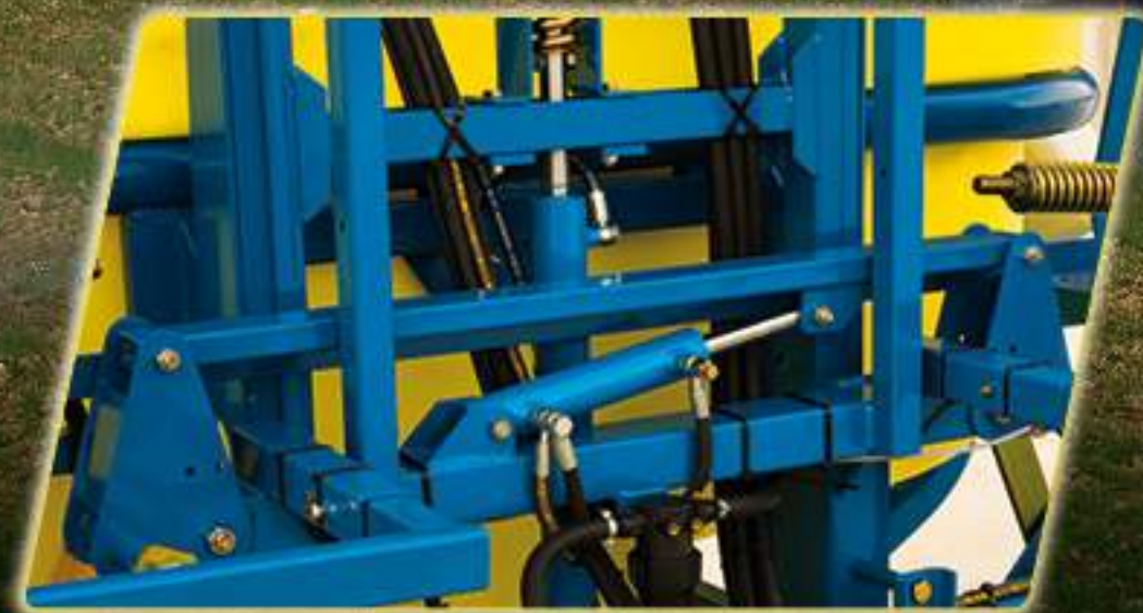
Corrector de giro para mantener el paralelismo de la barra con respecto a los terrenos inclinados con fuertes pendientes
